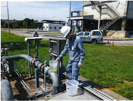
ภาพที่ 2-16 การตรวจวัดคุณภาพน้ำทิ้ง บริเวณบ่อกักน้ำทิ้ง
