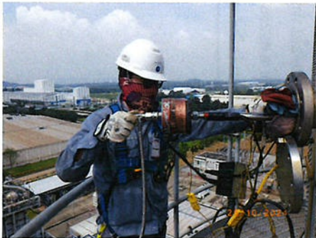
ภาพที่ 2-5 การตรวจวัดคุณภาพอากาศจากปล่องระบายอากาศด้วยวิธี Stack Sampling (ปล่อง HRSG 11 และปล่อง HRSG 12)
